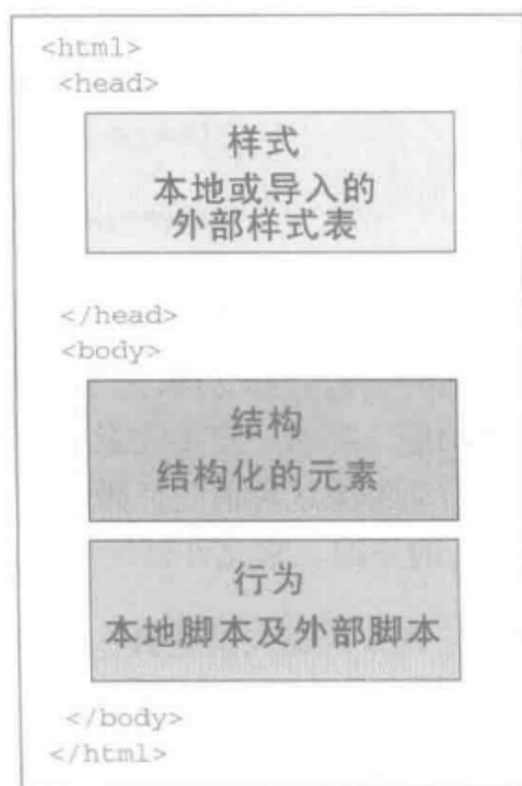
图 1.2 结构、样式和行为分离，可以最大化页面代码的可读性和可维护性
