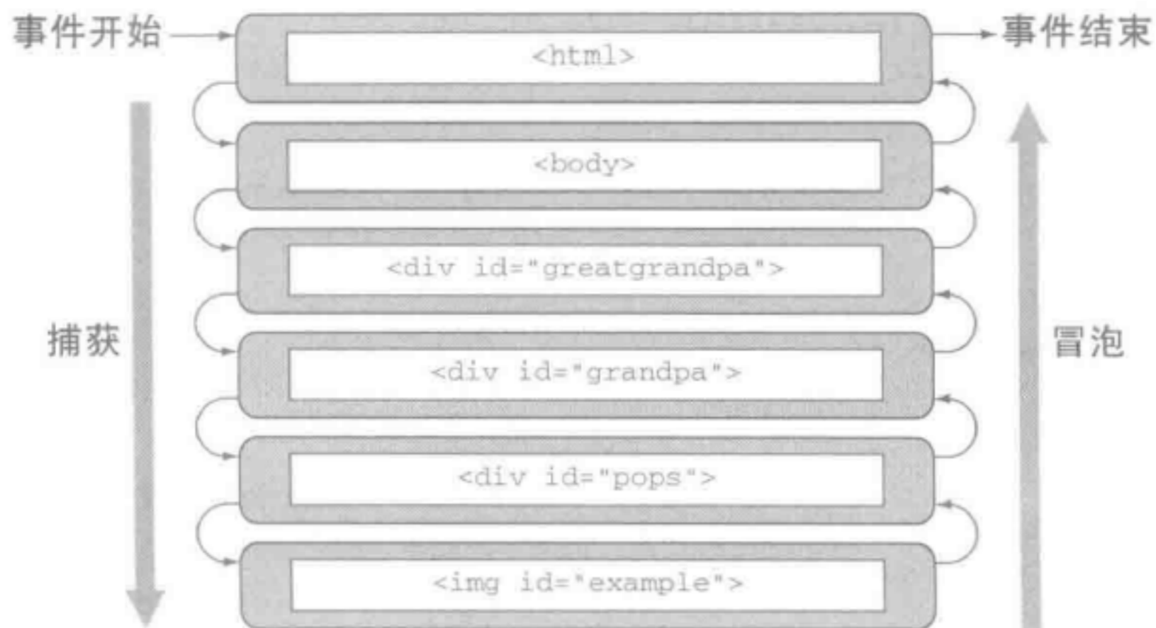
图 6.4 DOM 级别 2 事件模型中事件在 DOM 层级二次传播：一次从顶级到目标元素捕获阶段，一次从目标元素到根冒泡阶段
